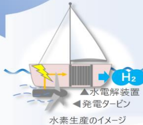
▲水電解装置 ▼発電タービン 水素生産のイメージ
