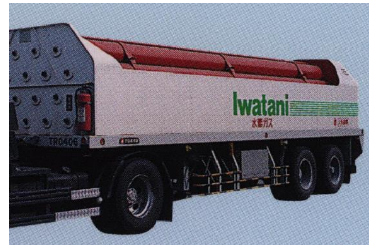
トレーラー（長尺シリンダー） 1,100 ~ 3,100 m 3
