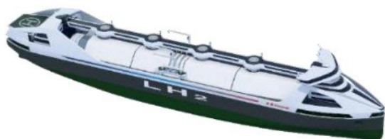
中型液化水素運搬船 4万m 3 (10,000m 3 × 4基)
