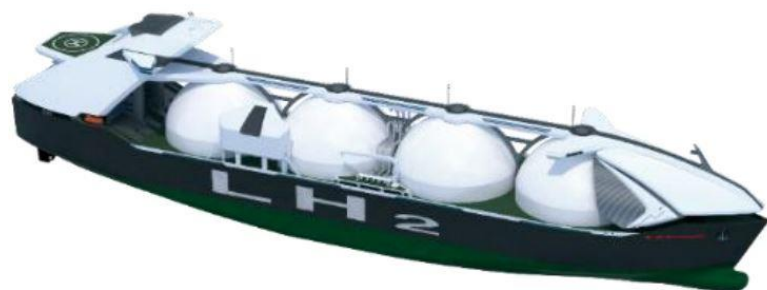
大型液化水素運搬船 16万m 3 (40,000m 3 × 4基)
