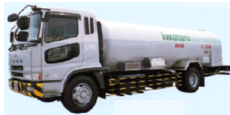
液化水素ローリー (圧縮水素の約12倍輸送可能)
